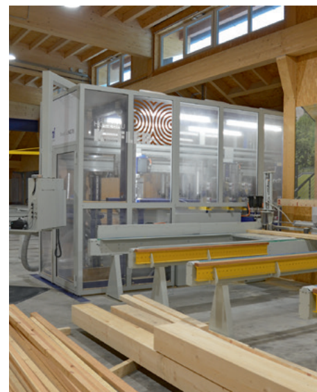
Seit einem Jahr arbeitet Holzbau Kofler mit diesem MC-15-Abbundzentrum von Krüsi
